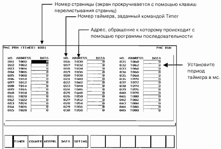
Установленное время таймера: Таймер 1-8 макс. 1572.8 сек и его точность 48 мс. Таймер 9-250 макс. 262.1 сек и его точность 8 мс.
